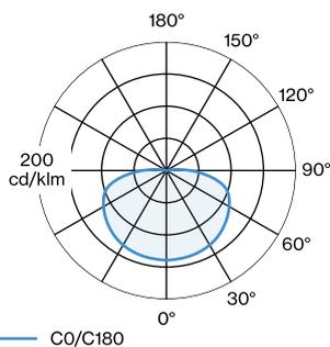
[2482E0BK1] I dati tecnici indicati sono valori caratteristici per una temperatura ambiente di 25°C. I dati relativi al flusso luminoso sono inizialmente soggetti a una tolleranza del +/- 10%, quelli relativi alla potenza di allacciamento a una tolleranza del +/- 10%, e quelli relativi alla temperatura di colore a una tolleranza di +/- 150 Kelvin. Non si risponde di eventuali refusi ed errori di stampa. The general terms and conditions of Wever & Ducré apply.
